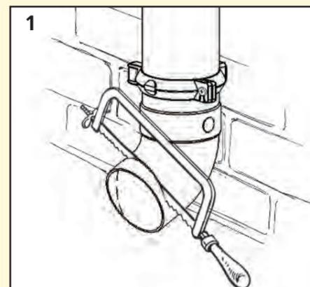
Нижний отвод можно обрезать параллельно стене для улучшения внешнего вида системы.
