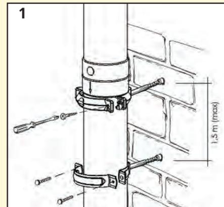
Расстояние между кронштейнами не должно превышать 1,5 м. Для большей надежности системы возможно применение металлических кронштейнов. Расстояние между ними также не более 1,5 м.
