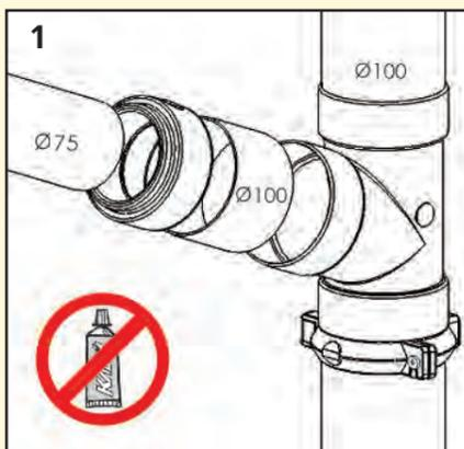
Тройники устанавливаются аналогично муфтам. В случае соединения трубы Ø75 мм с трубой Ø100 мм используется адаптер.
