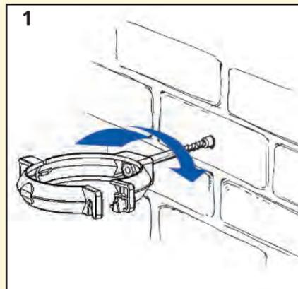
Кронштейны трубы монтируются на стене посредством универсальных дюбелей и специальных винтов.
