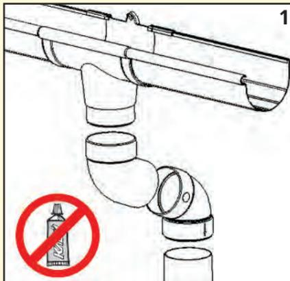
Монтаж труб начинают от воронки. При небольшом выносе крыши относительно фасадной стены используют муфту трубы или комбинацию одномуфтового и двухмуфтового отводов. Стрелка на муфтах и отводах указывает направление потока воды и всегда направлена вниз.
