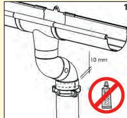
Непосредственно под отводом устанавливается кронштейн трубы. При вводе труб оставлять зазор примерно 10 мм для компенсации теплового линейного расширения. Клей не используется.
