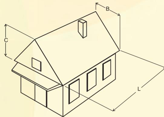
Эффективную поверхность крыши рассчитывают по формуле:  $E = (B + C/2) \times L$
