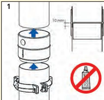
Для соединения труб применяются муфты. Стрелка на муфте указывает направление потока воды и всегда направлена вниз. Под муфтой устанавливается кронштейн. Нижняя труба вводится не до конца. Зазор примерно 10 мм. Клей не используется.
