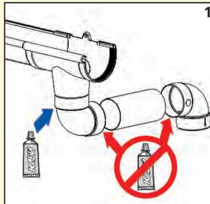
При значительном выносе крыши между двухмуфтовыми отводами применяется отрезок трубы. При этом обязательно приклеить верхний отвод к воронке. Возможно применение отводов с углом 87°.
